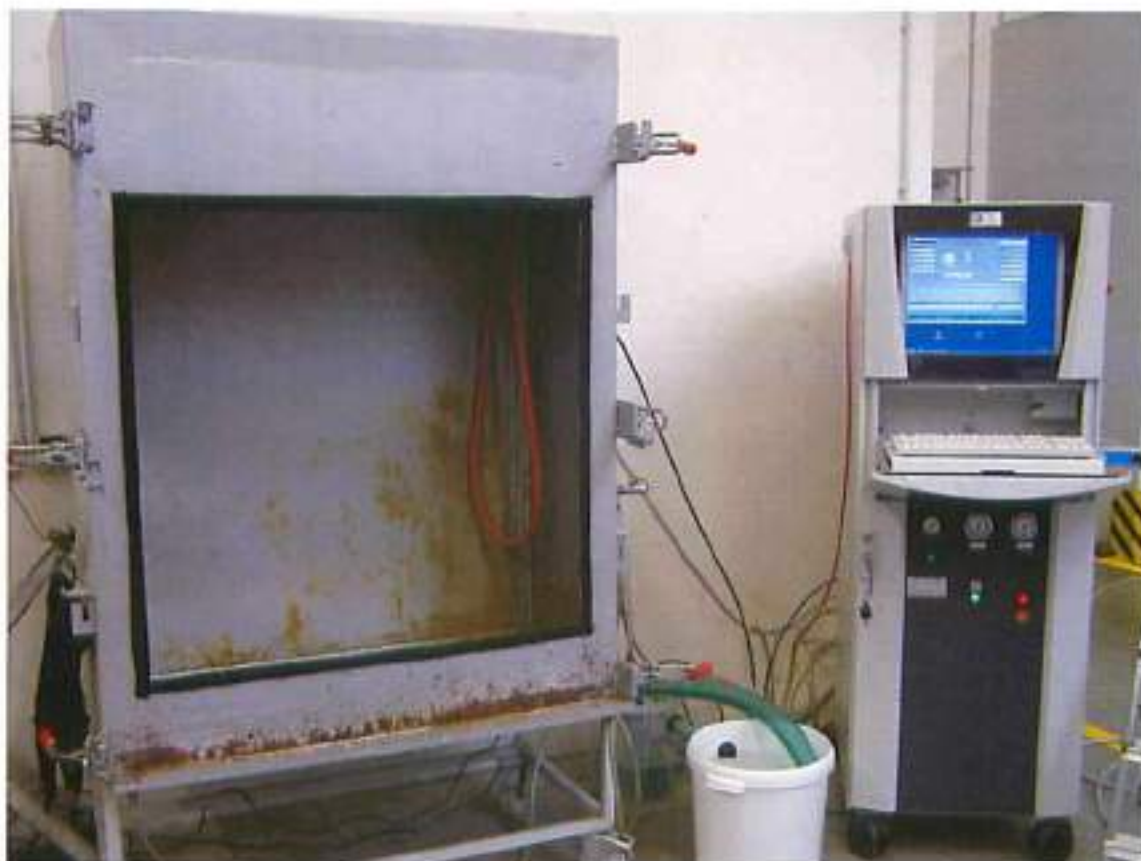
Photo 1: Banc d'essai sans éprouvette, avec dispositif de régulation
